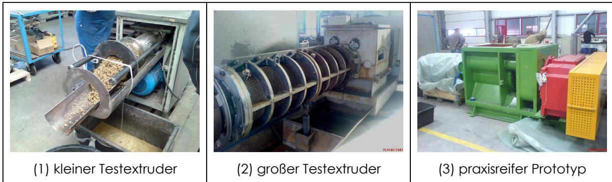
Abbildung 6: Realisierte Extrudervarianten
