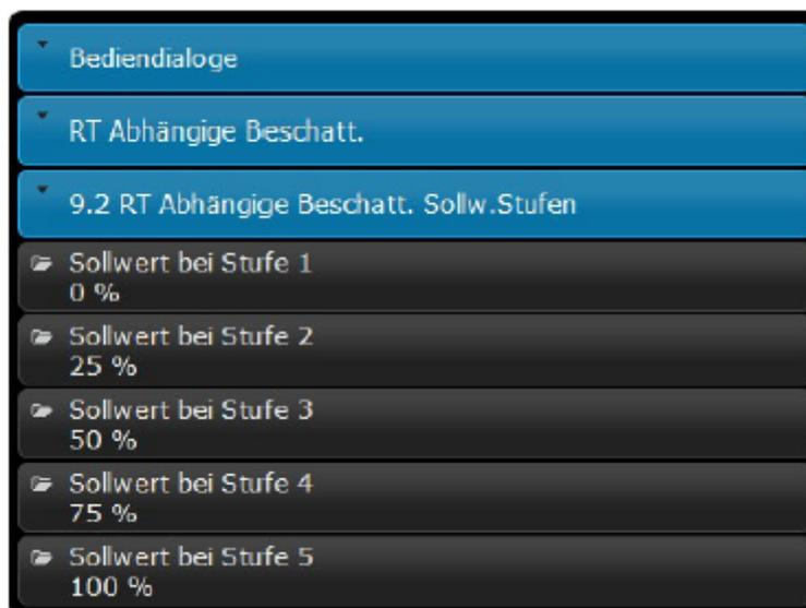
Abb. 37: Abdunkelungssollwerte für die 5 Stufen der E-Control-Verglasung
