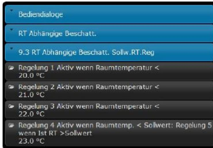
Abb. 38: Temperaturabhängige Auswahl der helligkeitsabhängigen Regelung
