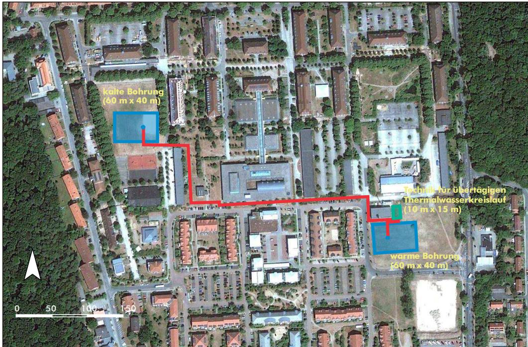
Abbildung 6-3: Anordnung der Installationen des Aquiferwärmespeichers (zwei separate Bohrplätze)
