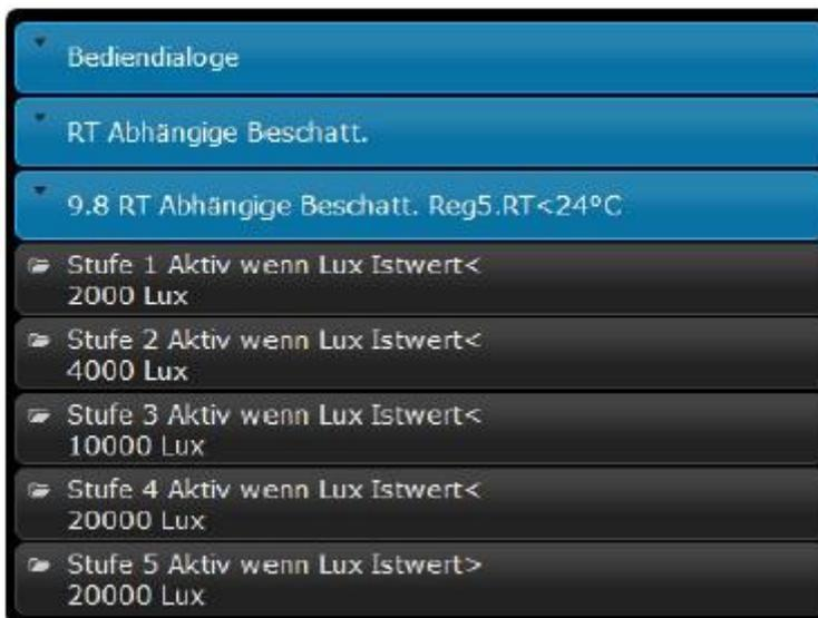
Abb. 39: E-Control-Regelung im Sommerfall > 24°C (max. Wärmeschutz)
