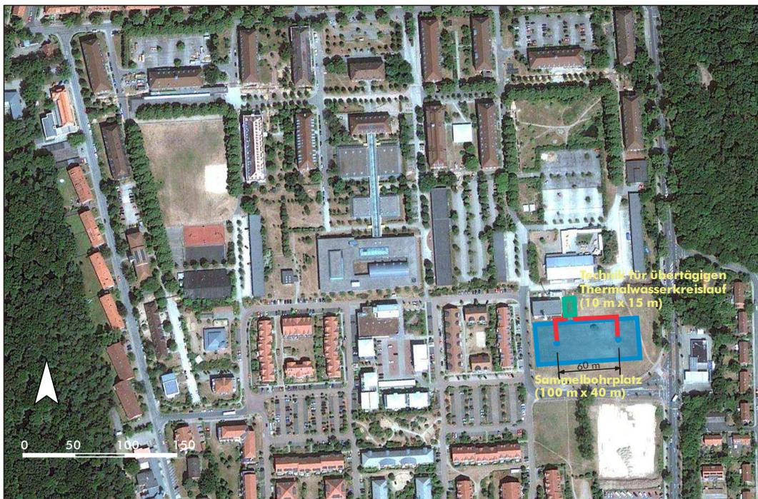
Abbildung 6-4: Anordnung der Installationen des Aquiferwärmespeichers (Sammelbohrplatz)
