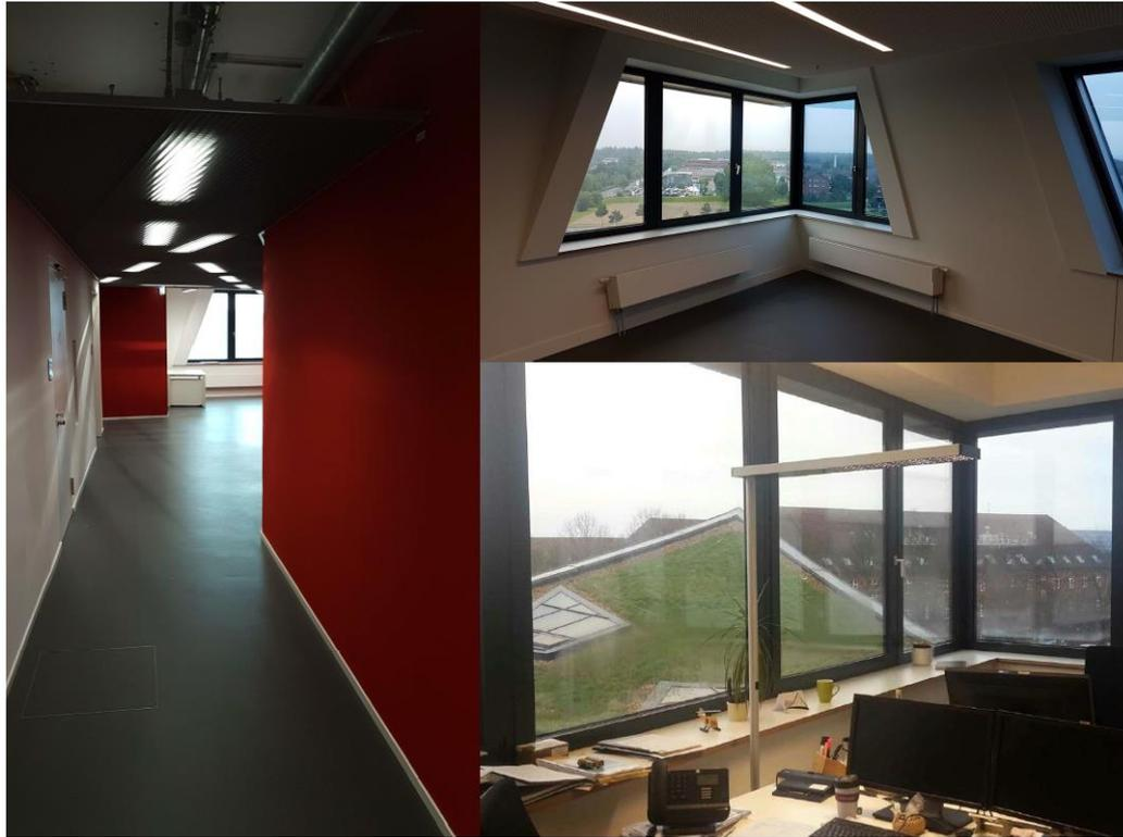
Abb. 47: Mit E-Control ausgestattete Bereiche im Forschungszentrum: Flur (l.) mit Kommunikationsinsel (im hinteren Bildbereich), Open-Space-Bereich im 5. OG mit Tages- und Kunstlichtsystem (Bereichsweise DALI-gesteuerte Leuchten mit Präsenz- und Tageslichtsensor) zu erkennen ist außerdem die fassadenweise gesteuerte E-Control-Verglasung) sowie mit E-Control und LED-Stehleuchte ausgestattetes Einzelbüro.
