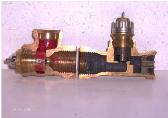
Abb. 32: Längsschliff eines ausgefallenen Ventils nach einjährigem Betrieb. Stufen 1-3 sind nicht mehr einstellbar. D. Malinowsky.
