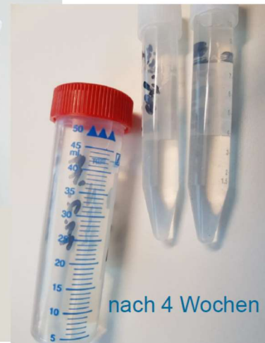
Abb. 73: Intensiv grün gefärbter Komplex "Green Rust" als Vorstufe der Magnetitbildung (Heizkreislauf Leuphana Zentralgebäude)
