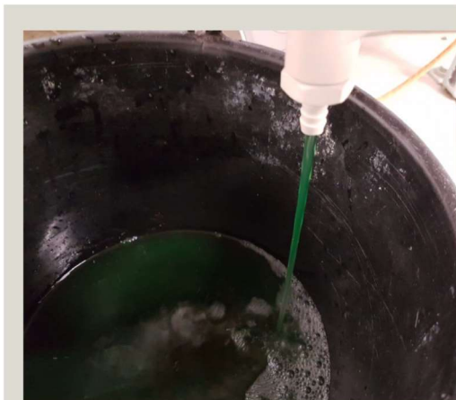
Abb. 73: Intensiv grün gefärbter Komplex "Green Rust" als Vorstufe der Magnetitbildung (Heizkreislauf Leuphana Zentralgebäude)
