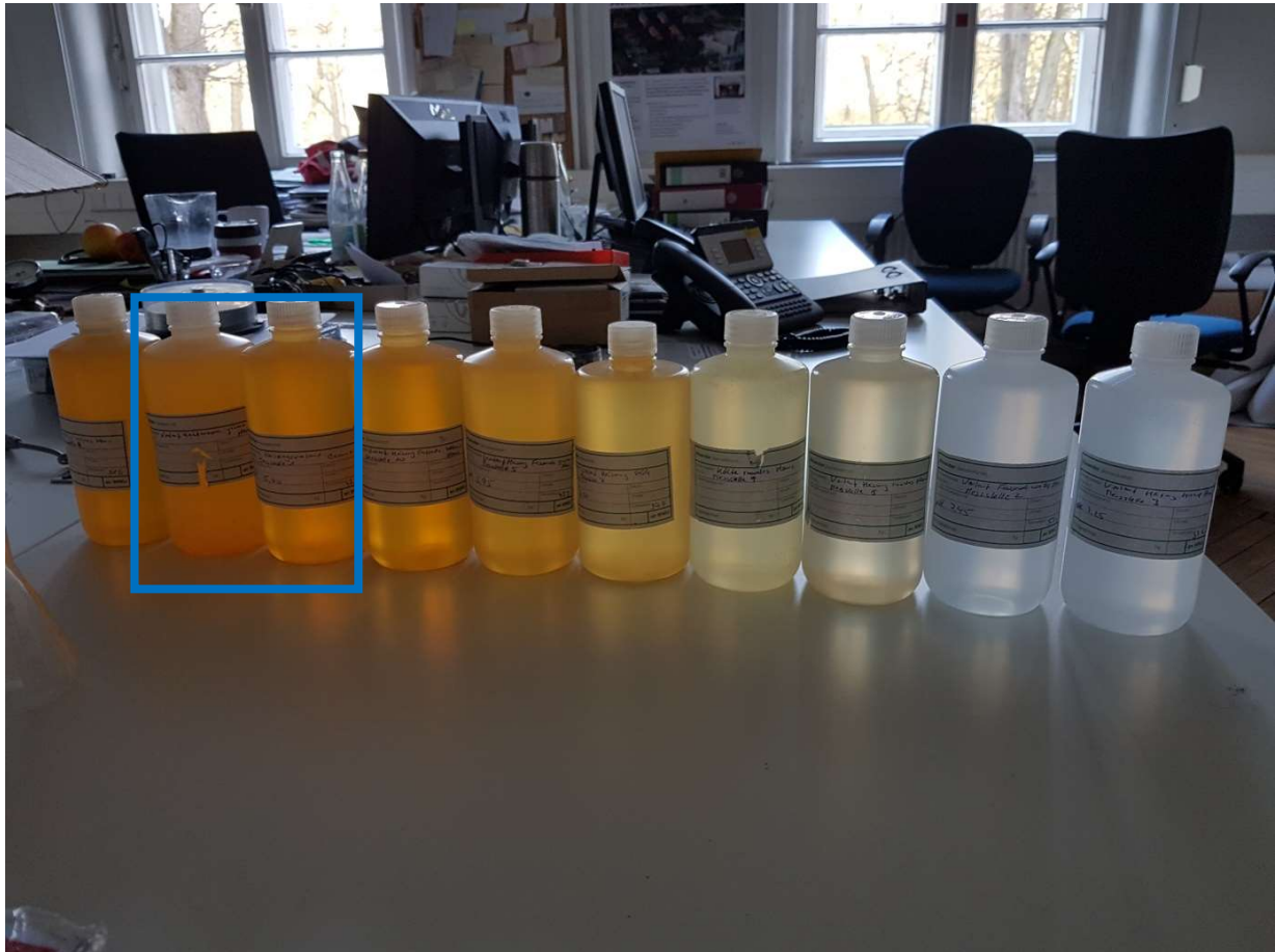
Abb. 56: Proben vom Objekt 9. Die Proben des sanierten Systems sind markiert
