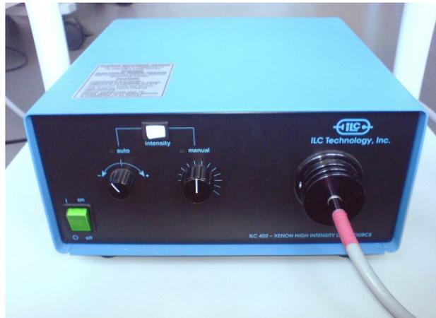
**Abb 14: Lumatec Lichtquelle mit Xenon-Quecksilber-Lampe**
