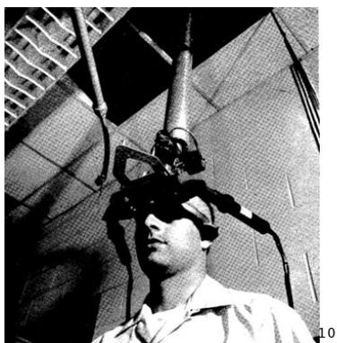
und den beiden Augen wird dann ein Ausschnitt einer vom Computer berechneten virtuelle Szene angeboten, die genau der Kopfbewegung folgt:
