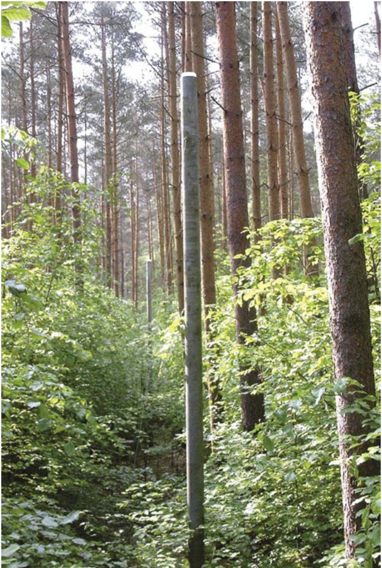
Messung des Niederschlags unterhalb der Kiefernkronen in einem Kiefern-Buchen-Mischbestand (Foto: Institut für Forstökologie und Walderfassung Eberswalde, BFH)
