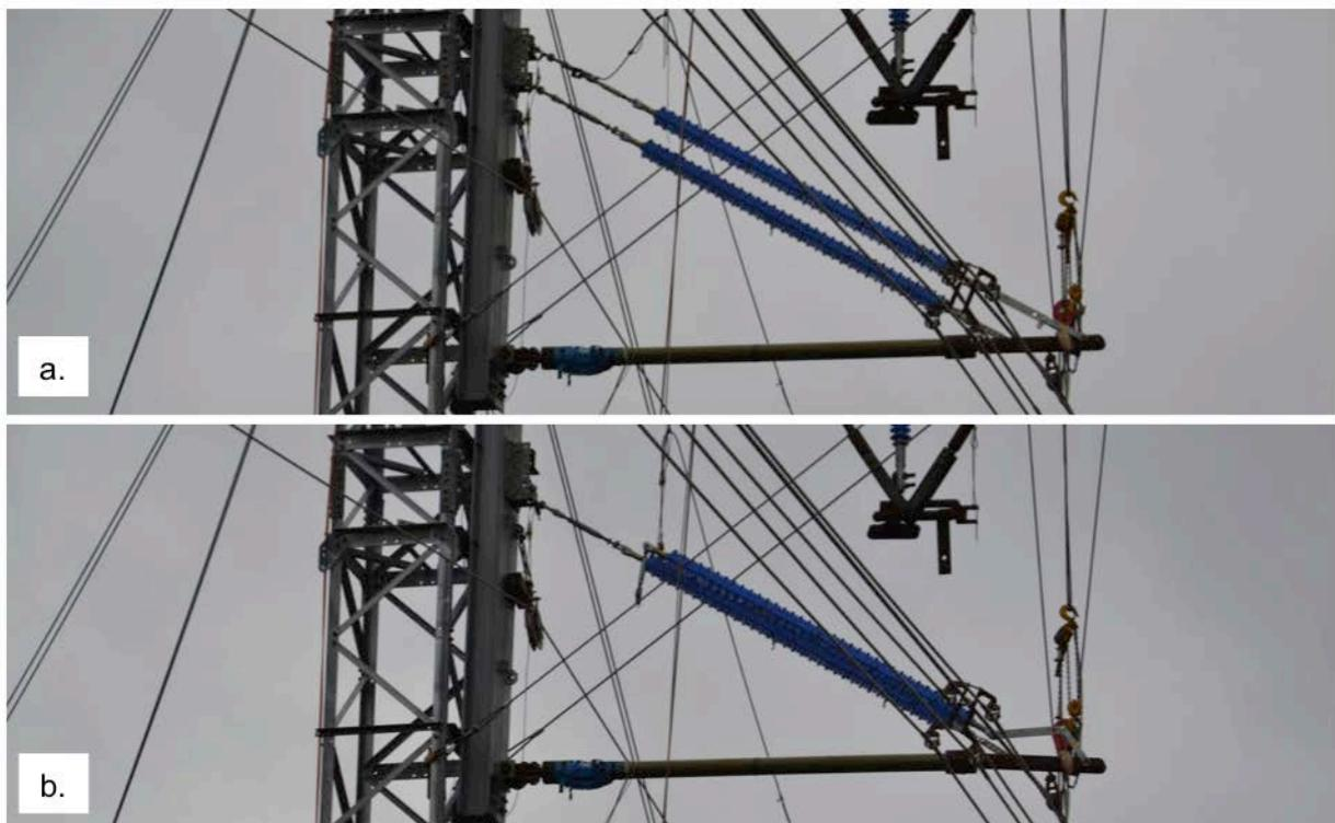
Abb. 15: Asymmetrische Kette mit horizontalem Druckstab vor (a.) und nach (b.) dem Versuch.
