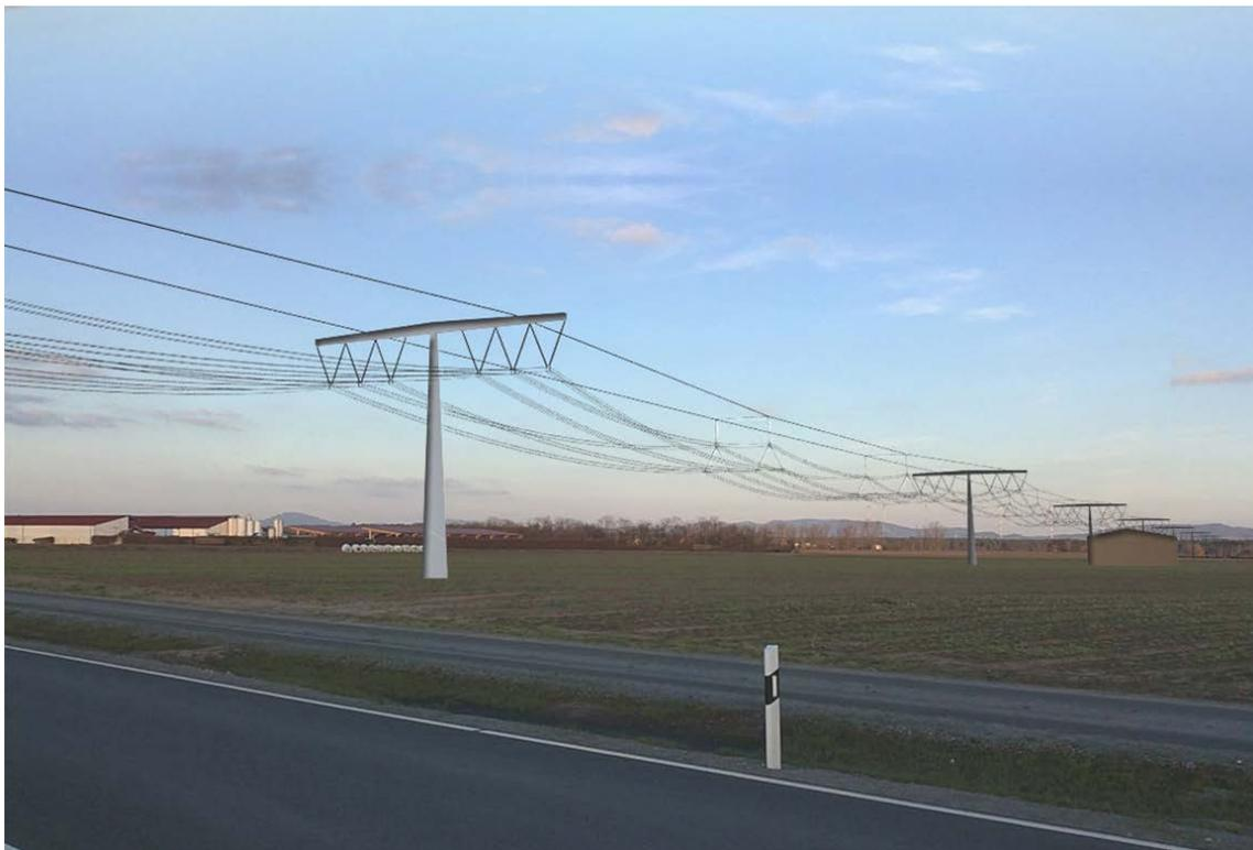
Abb. 5: Visualisierung einer Leitung mit Abhängung am Erdseil
